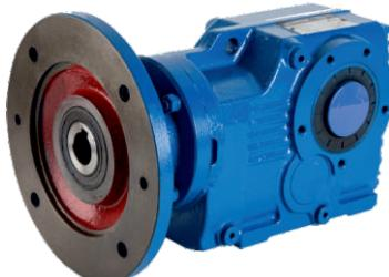
Коническо-цилиндрические редукторы **VRC** – это одна из разновидностей цилиндрического редуктора. Отличается от других цилиндрических редукторов тем, что выходной вал редуктора расположен к входному валу под углом 90 градусов. Основу редуктора также составляют зубчатые передачи, но имеют конические шестерни. Оси валов конических шестерен имеют угол пересечения 90 градусов. Передача усилия конического редуктора такая же, как и у всех цилиндрических редукторов.
